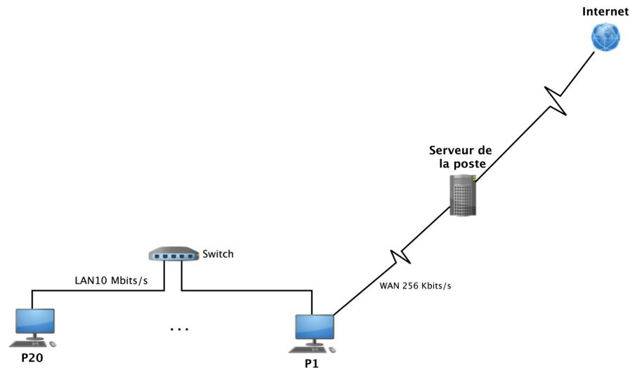
Les postes de P1 à P20 sont reliés par le réseau LAN offrant un débit de 10 Mbits/s à travers le switch. Le poste P1 est relié aussi au réseau WAN de la poste offrant un débit de 256 Kbits/s à travers une carte modem.
